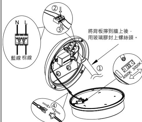
5. 將燈具連接好外部電源，調節到所需要的色溫後將燈具公母插線連接好。
