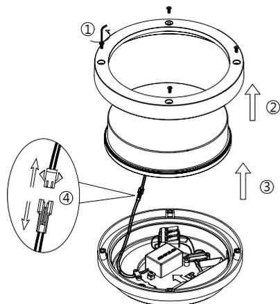
1. 斷開電源，按圖步驟拆開燈具。
