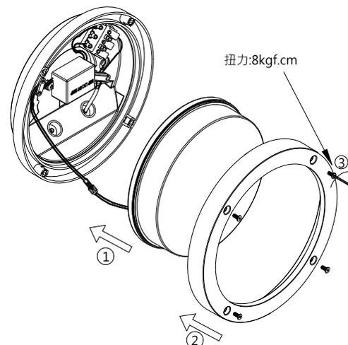
6. 按圖步驟將燈具安裝好並鎖緊螺絲。
