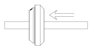
電源線穿透防水塞并接上燈具後, 將電源線外推收線,同時將防水 塞進線口向外翻轉。
