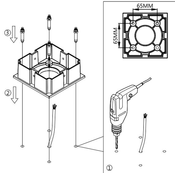
2. 按圖示尺寸·將底座安裝在安裝面上。
