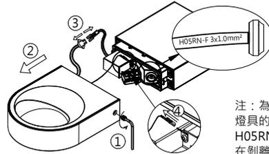
注：為了達到要求的IP，燈具的輸入電纜必須為H05RN-F3G1.0mm<sup>2</sup>，並在剝離前穿線。
