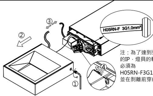
注：為了達到要求的IP·燈具的輸入電纜必須為H05RN-F3G1.0mm<sup>2</sup>·並在剝離前穿線。
