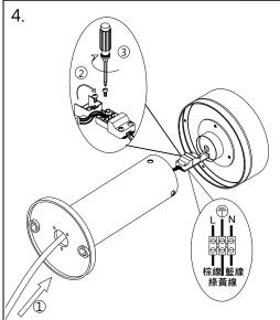
4.將外部電纜線經燈具底盤穿入到燈柱上·將電源線 連接好燈具輸入端端子。
