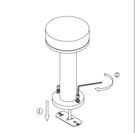
6.將燈具底盤與固定板裝好並扭緊底盤與固定板之間的螺絲。
