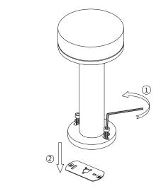
1.斷開電源,用內六角扳手逆時針扭出螺絲,將固定板取下。
