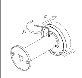
2.用內六角扳手逆時針方向旋轉扭出燈柱螺絲‧將圓頂蓋取出。
