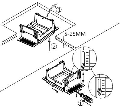
4.將預埋框安裝到挖孔處，調節好框架的高度後鎖緊螺絲。
