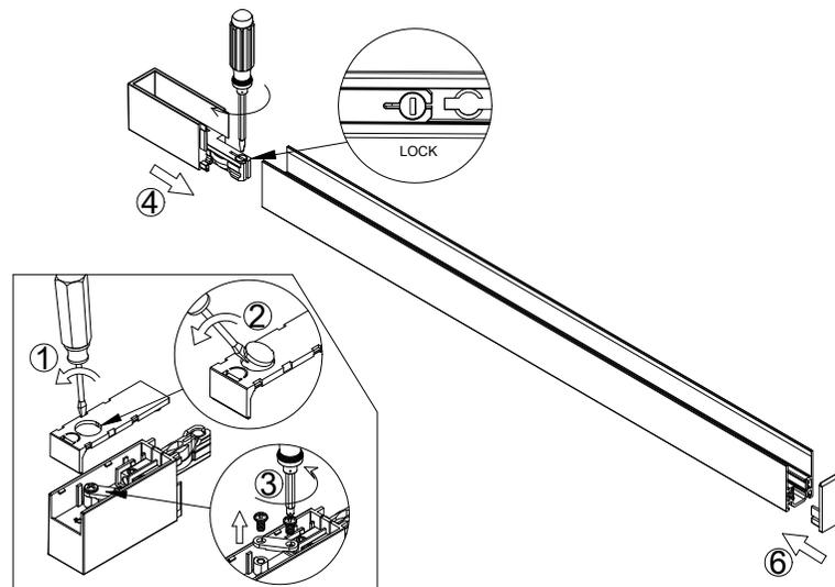
1. 斷開電源·將軌道電源頭裝入軌道並用螺絲刀順時針鎖緊·再將尾塞裝入軌道尾端。
