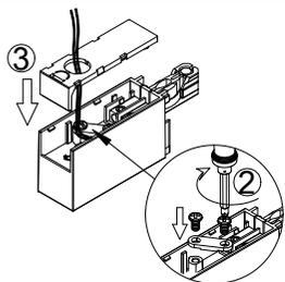
2. 取下電源頭上蓋將外部低壓電源線連接上電源頭·再將電源頭蓋子裝回·將軌道用零件包螺絲選擇合適工具將螺絲與軌道鎖緊在天花板上。
